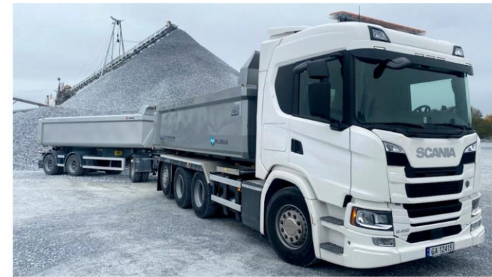
Scania G410-en fikk det slitsomt i de bratteste bakkene med 60 tonn totalvekt. Når det om litt kommer sterkere biogassmotorer, er planen til Verdalskalk i Trøndelag å bruke dem til vogntog med totalvekt på 70 tonn. Foto: Verdalskalk
